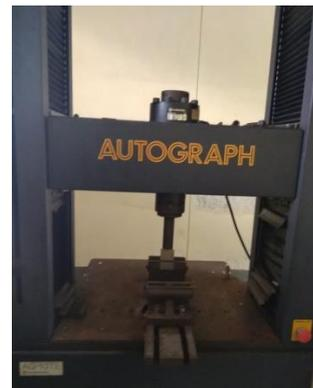
Gambar 7. Pengujian Tekuk
