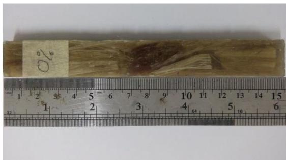
Gambar 5. Spesimen Uji Tekuk
